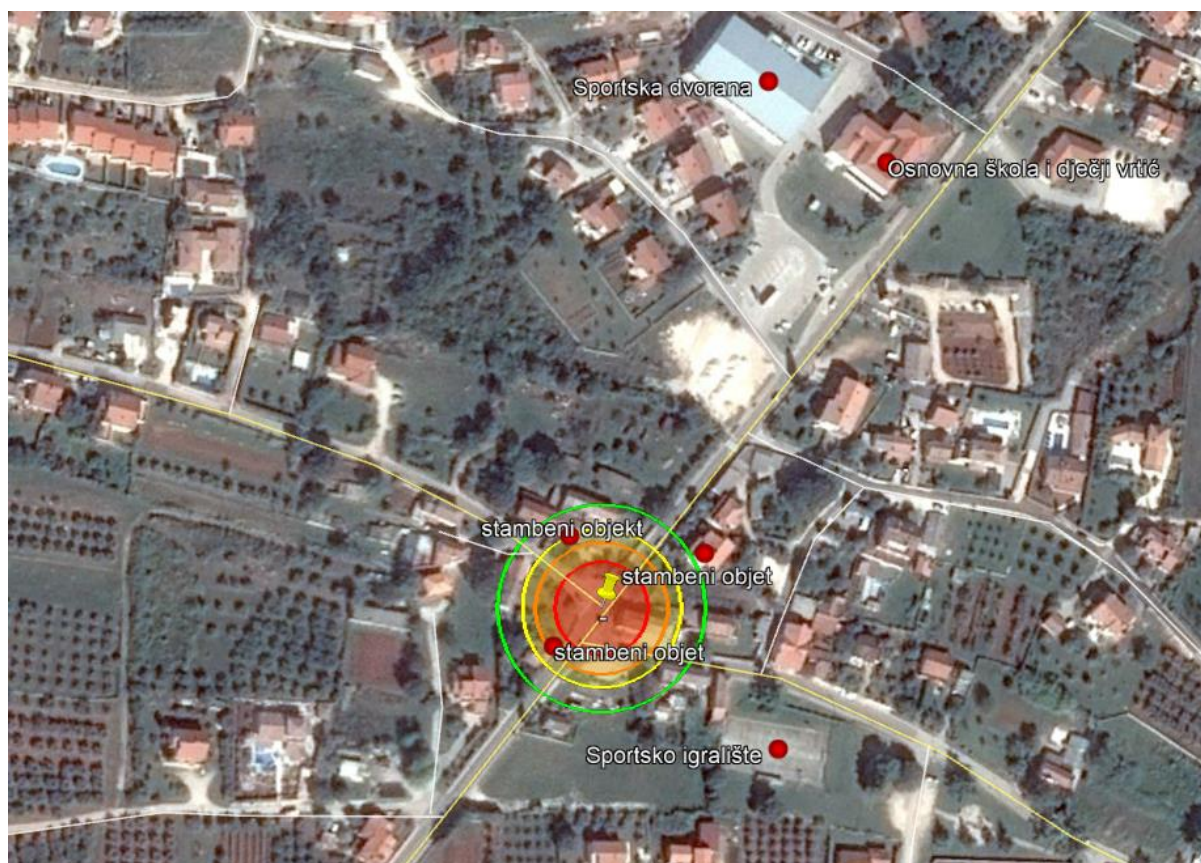
Slika 9. Prikaz zone ugroženosti u slučaju ispuštanja lož ulja iz autocisterne kapaciteta 35 m 3 i nastanka požara
